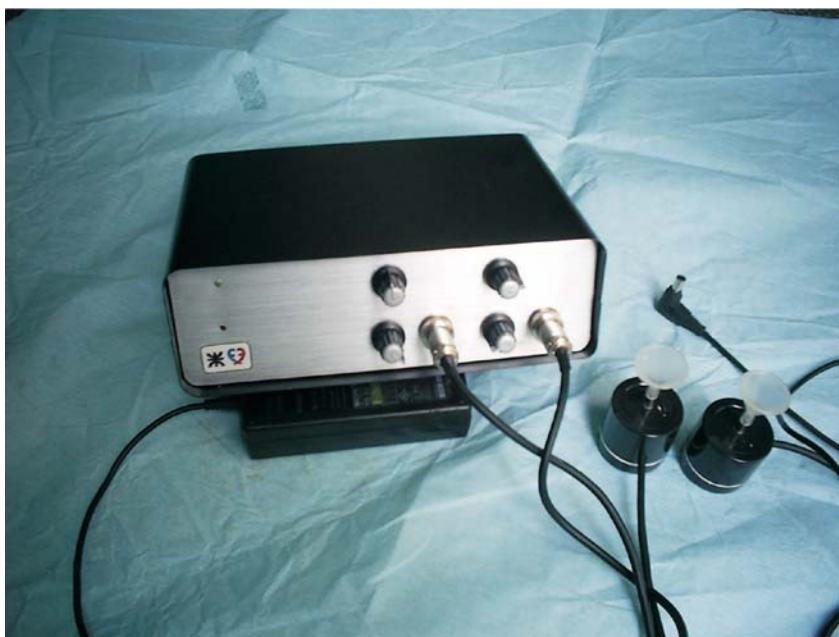
Figura 2. Prototipo de dispositivo para la determinación automática de la Velocidad de la Onda del Pulso desarrollado en la Facultad Regional Buenos Aires.
