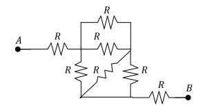
**Ejercicio 7**: dado el arreglo de la figura halle la resistencia equivalente entre A y B (todas las resistencias valen R)
