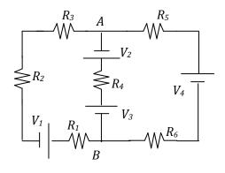
**Ejercicio 10:** los valores de los diferentes elementos del circuito de la figura son:  $R_1$ = 5  $\Omega$ ,  $R_2$ = 5 $\Omega$ ,  $R_3$ = 10  $\Omega$ ,  $R_4$ = 20  $\Omega$ ,  $R_5$ = 10  $\Omega$ ,  $R_6$ = 10  $\Omega$ ,  $V_1$  = 15V,  $V_2$  = 5V,  $V_3$  = 10V y  $V_4$  = 5V.
