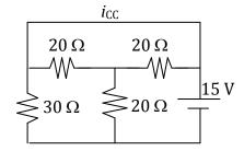
*Ejercicio 12:* calcule la intensidad de corriente que circula por el cortocircuito del arreglo de la figura.
