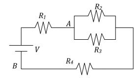
**Ejercicio 4:** En el circuito de la figura, la resistencia  $R_3$  disipa 10 W. Para V =133 V,  $R_2$  = 750 Ω,  $R_3$  = 250 Ω,  $R_4$  = 100 Ω, calcule
