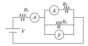
*Ejercicio 9:* los instrumentos del circuito de la figura no son ideales. Los amperímetros tienen resistencia interna de  $1\Omega$  y el voltímetro tiene resistencia interna de 1 k $\Omega$ .
