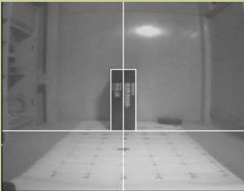
Se ubica el cursor en el punto objetivo sobre la pantalla, y se puede comprobar que la caja dibujada tiene las mismas dimensiones que la real ubicada en ese punto
