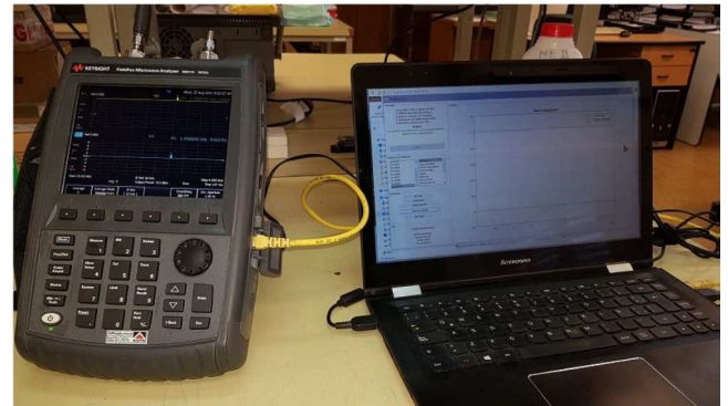
Fig. 10. Sistema de medición: VNA y software de control y procesamiento de datos
