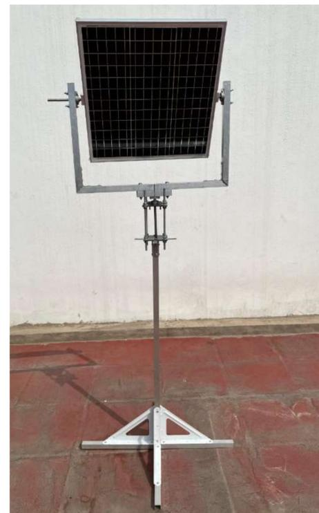
Figure 2:Estructura seguidor
